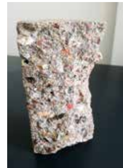
Rdzenie odwiercone po 70 dniach z nawierzchni drogi – Dmax=16, grysy
