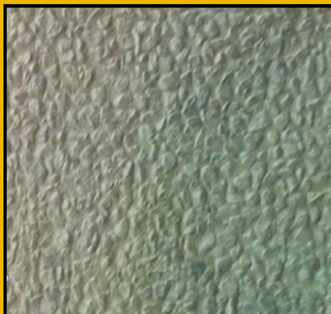
Próbka B, GWB 8 2 frakcje kruszywa Większe „upakowanie” grysów.
